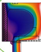
Avec une valeur U de 0,50 W/m<sup>2</sup>K, le volet Thermo OB910 offre la meilleure valeur d'isolation du marché. Le confort acoustique augmente également : 49 dB lorsque le volet roulant est baissé et jusqu'à 49 dB lorsqu'il est relevé. Ce volet roulant réduit ainsi le bruit d'une autoroute au son des feuilles qui bruissent.
