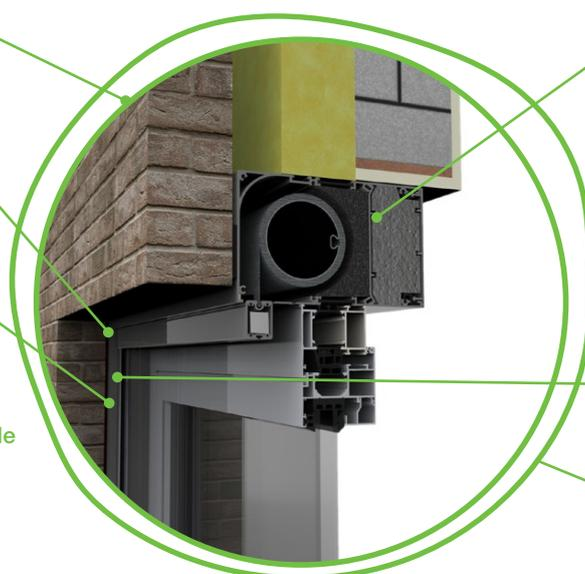
4 Isolation thermique (1.3 W/m2K) et acoustique (54 (0;-3) dB) du caisson
